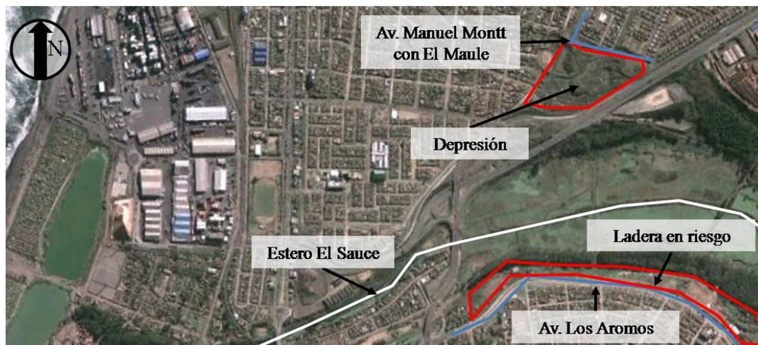
Figura 50: Puntos Críticos Barrancas Alto y Lolleo Alto
