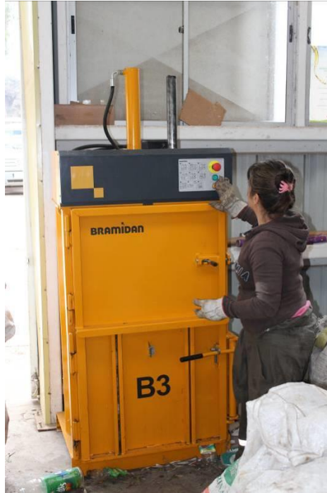
Figura 11: Compactación de residuos
